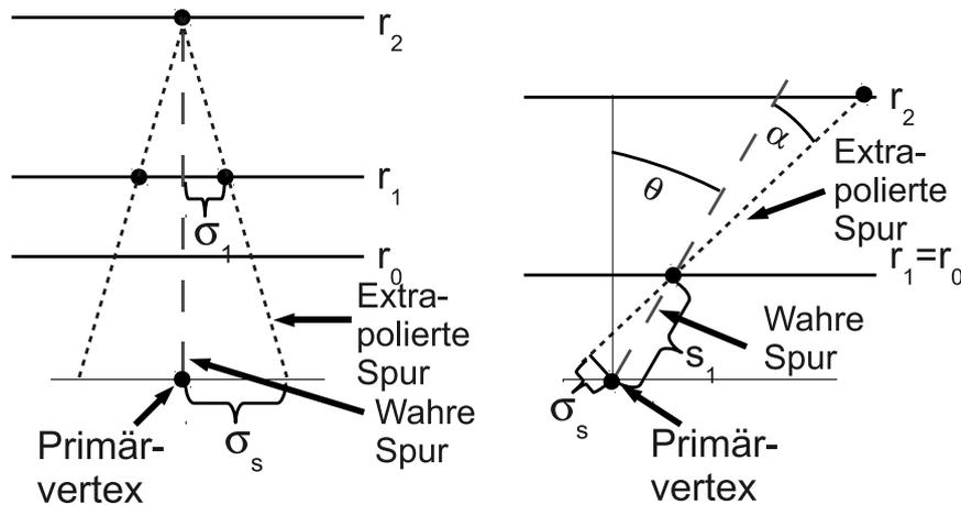
Abbildung 2: Idealisierter Detektor zur Vertexmessung. Links - zum geometrischen Fehler:  $r_1$  (Abstand der Strahlröhre zum Punkt der Teilchenkollision, dem sogenannten Primärvertex) und  $r_2$  sind die Abstände der Detektorlagen 1 und 2 zum Primärvertex,  $r_0$  der Radius der Strahlröhre. Rechts - zum Fehler durch Vielfachstreuung: Vereinfachung durch die Annahme  $r_1 = r_0$ .
