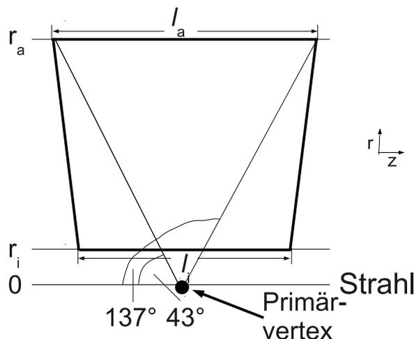
Abbildung 1: OPAL-Jetkammer. Diese besteht aus 159 Drähten im Abstand von jeweils 1 cm. Der innerste Draht befindet sich in einem Abstand von  $r_i = 255$  mm vom Kollisionspunkt; der äußerste im Abstand von  $r_a = 1835$  mm. Die Drahtlänge in z-Richtung beträgt in der innersten Lage  $l_i = 160$  cm, in der äußersten  $l_a = 200$  cm. Der gesamte Aufbau ist radialsymmetrisch. Das Koordinatensystem ist rechts dargestellt; der Ursprung befindet sich im Kollisionspunkt (Primärvertex).
